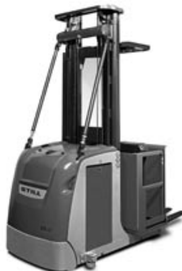
ЕК-Х с телескопической мачтой, габаритная высота 2400/2900 мм
